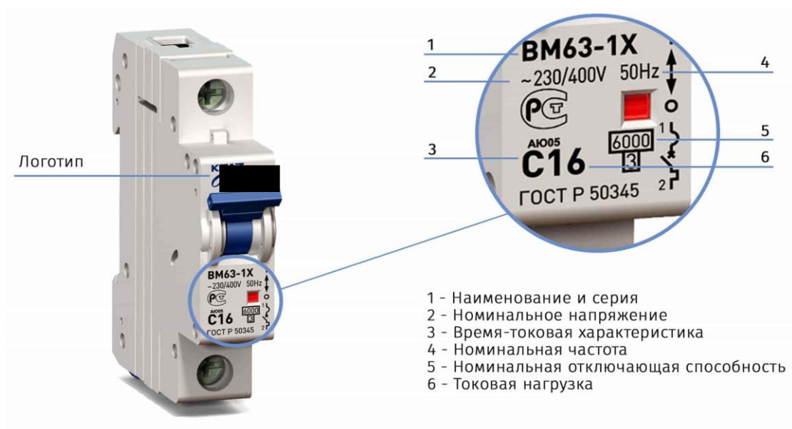
Рисунок 2. Пример маркировки АВ
